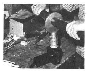
In 1 Minute können Sie ein defektes Kunststoffrohr dauerhaft mit dem Leister-Ghibli im Spiegel-Schweissverfahren reparieren. Auch die Herstellung von Rohr-Bögen und Abzweigungen ist so durchführbar.
