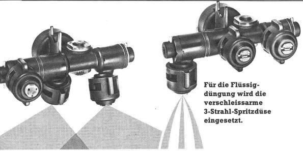
Es können Träger nit 2, 3 oder 4 Düen montiert werlen. Alle Düsen cönnen bis max. 20° lach vorn oder hinen schräggestellt verden und erlauen jede Applikaion. Die neuen Mehrfachdüsenträger
