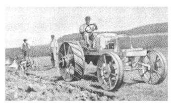
Aus verschiedenen Lastwagenteilen hergestellter Traktor mit Martini-Motor (ca. 1919).
