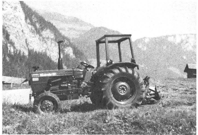
Abb. 1: Es ist dringend, dass auch Alttraktoren mit einer Fahrerschutzvorrichtung ausgerüstet werden wie der abgebildete Traktor neuerer Generation. Nur so können die tödlichen Stürze weiter vermindert werden.
