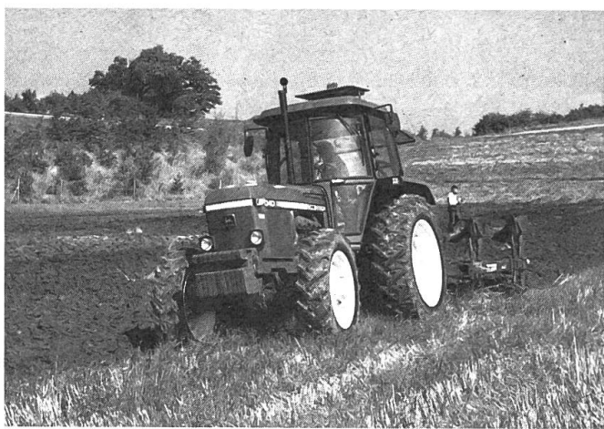
Abb. 2: Kabinen, insbesondere Komfortkabinen, bringen nicht unbedingt mehr Sicherheit bei Stürzen als Rahmen oder Bügel, bieten aber einiges mehr punkto Gesundheitsschutz.
