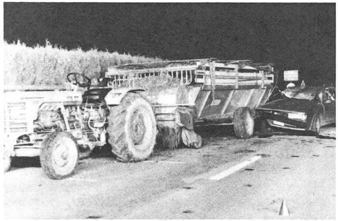
Abb. 4: Blinkanlagen an Traktoren und Anhängern sollten heute nicht mehr fehlen. Auffahrkollision wegen fehlender Beleuchtung am Anhänger.
