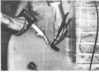
Reparaturschweissen Polyäthylenan einem Behälter. Viele Behälter, Rohre, Körbe und Eimer bestehen aus dem gut schweissbaren Polyäthylen.
