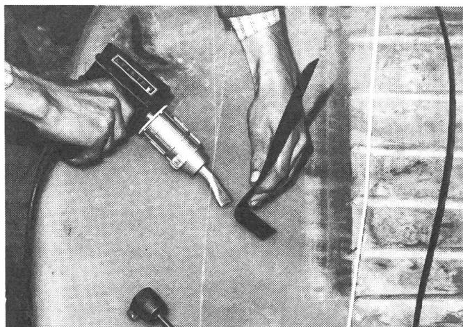
Reparaturschweissen an einem Polyäthylen-Behälter. Viele Behälter, Rohre, Körbe und Eimer bestehen aus dem gut schweissbaren Polyäthylen.
