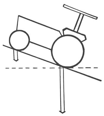
Bergwärts: Gewichtsverlagerung nach hinten, das heisst zugunsten des hinterradangetriebenen Traktors.
