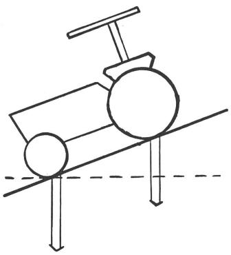
Talwärts: Gewichtsverlagerung nach vorn, das heisst zugunsten des vierradangetriebenen Traktors. Eine Situation, die vor allem auch beim Rückwärts-Fahren (manövrieren) und beim Bremsen im Hänggelände von Bedeutung sein kann.
