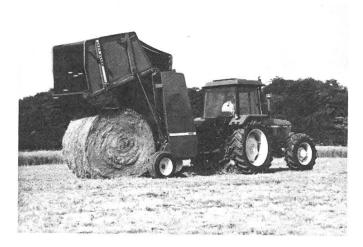
Mit der neuen *Rundballenpresse 550* kann nun – bei variabler Ballengrösse – alles gepresst werden: Silage, Heu oder Stroh.
