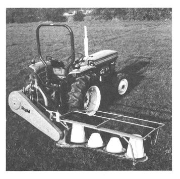
benmäher arbeitet absolut stopfungsfrei weil der bisher übliche Innenschuh fehlt. Die starke Federentlastung sowie der problemlose 3-PT-Anbau sind weitere Vorteile dieser RAPID-Neuheit. Auf Wunsch ist ein hydr. Aufzug sowie ein Anbaubock für Traktoren mit Doppelbereifung erhältlich.
