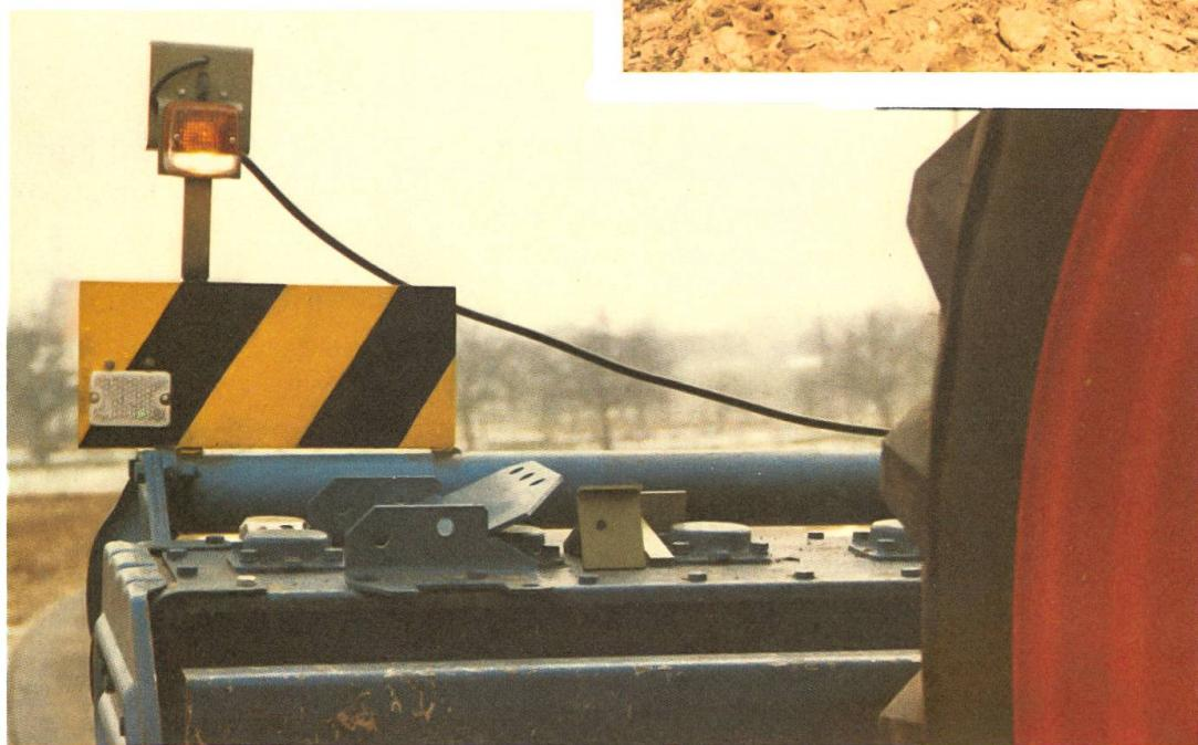
freie Funktionieren der Maschine, ist deren vorschriftsgemäße Ausrüstung für die Straßenfahrt. Sehen und gesehen werden kann von der einwandfreien Signalisierung und Beleuchtung abhängen. Also fordern Sie diese bereits beim Kauf der neuen Maschine. Fotos SVLT Bü
