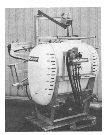
Wer sich für den Komfort eines vollhydraulisch zu betätigenden Spritzbalkens mit Hubwerk und Hangverstellung (ebenfalls hydraulisch bedient) interessiert, wird diese Ausrüstung auf dem BIRCHMEIER-Stand finden. Die 12 und 15 m breiten vollhydraulischen Spritzbalken sind mit Mehrfachdüsen ausgerüstet. Der 15 m breite vollhydraulische Spritzbalken ist auf einem Geräteträger Fendt mit 1100-I-Behälter aufgebaut. Diese selbstfahrende Motorspritze bietet jeden gewünschten Spritzkomfort.
