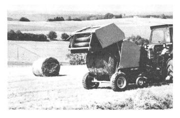
gewicht bei Stroh 120-160 kg und 160-250 kg bei Heu. Ballenzähler serienmässig. Maschinenhöhe 2,03 m, Gewicht 1590 kg. Als Zugkräfte genügen Traktoren ab 33 kW (45 PS).
