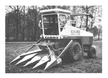
biss und eine 2 m breite Pickup-Trommel für die Grasernte. Neu ist, dass die Vorsatzgeräte auf die jeweilige Fahrgeschwindigkeit optimal eingestellt werden können. Die Häcksellänge ist in 6 Stufen vorwählbar. Ein Metalldetektor gehört zur Serienausrüstung: Der Detektor in den Einzugswalzen spürt sicher Eisen- und Stahlteile auf und setzt dann Zuführ- und Einzugsorgane blitzartig still. Die Maschine wird so vor Beschädigungen bewahrt.
