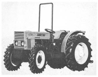
Vier neue Schmalspurmodelle von 35,3 kW (48 PS) bis 50 kW (68 PS) ergänzen das bisherige Angebot an Spezialtraktoren. Die Typen 470 DT/V, 570 DT/F und 670 DT/F sind mit Allradantrieb und der Typ 570 F mit Hinterradantrieb ausgerüstet.
