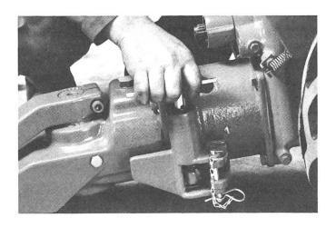
Nun hat BUCHER-GUYER eine ganz neue Idee verwirklicht: Mit einem zum Werkzeugsatz gehörenden Steckschlüssel kann die Bedienungsperson eines BUCHER M 500 den Pendelausgleich des Mähbalkens am Ausleger individuell nach seinen Wünschen und Terrainverhältnissen auf einfache Art schnell einstellen. Dadurch kann der Seitenzug voll neutralisiert werden. Zudem entfällt mit dieser Neuerung die Balkenarretierung beim Anhängen des Mähers an den Ladewagen.
