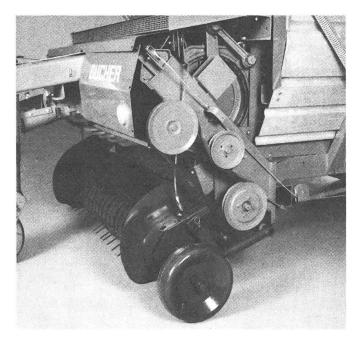
restlos aufgenommen. Die Zinkenführungen sind neu aus Federstahl gefertigt, das heisst, beim Anfahren an ein Hindernis verbiegen sie sich nicht, sondern federn elastisch zurück. Die Vollpendel-Einrichtung sorgt für beste Anpassung an jede Bodenunebenheit.
