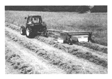
der Messerbahnen erzielt. Zusammen mit dem extrem flachen Scheibenträger garantiert dies einen sauberen, verstopfungsfreien Schnitt.
