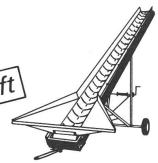
Gummi-Förderbänder Gurt flach, muldenförmig oder Wellenkante
