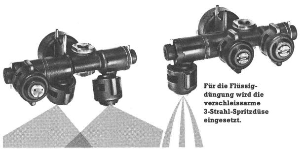
Es können Träger mit 2, 3 oder 4 Düsen montiert werden. Alle Düsen können bis max. 20° nach vorn oder hinten schräggestellt werden und erlauben jede Applikation. Die neuen Mehrfachdüsenträger mit einem zentral integrierten Antitropf-Ventil machen die Spritzarbeit noch wirkungsvoller und wirtschaftlicher.
