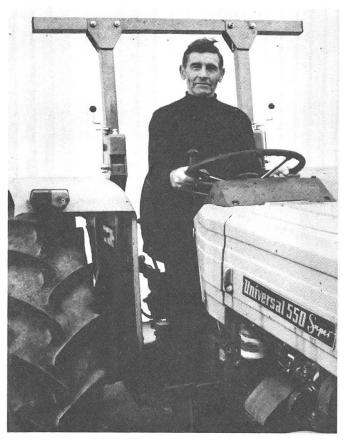
Abb. 2: Sicherheitsbügel in Schutzstellung.
