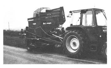
Abb. 5: Futterrübenvollernter BvL van Lengerich mit Rollbodenbunker.
