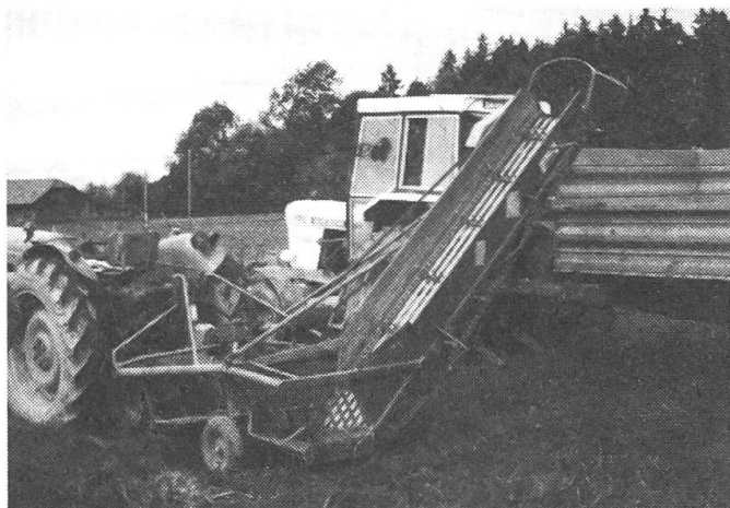
Abb. 2: Der Rodelader Thyregod ist eine einfache Maschine. Die geköpften Rüben werden zweireihig durch Rodeschare aus dem Boden gehoben und gelangen auf einen Siebstern. Der Siebstern befördert sie auf den Schrägförderer, welcher die Rüben in den nebenan-fahrenden Wagen transportiert.
