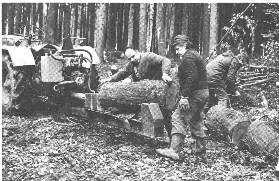
Abb. 8: Mit enormer Kraftanstrengung und ungünstigen Körperhaltungen wird diese horizontal arbeitende Spaltmaschine beschickt. Das Gewicht des Eichenrugs dürfte 100 kg betragen (Foto BAF, L. Rigling).
