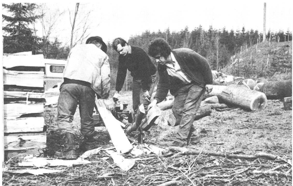
Abb. 7: Diese horizontal arbeitende, leichte Spaltmaschine mit eigenem Antrieb wurde direkt vor der Sterbeige plaziert. Die schweren Rugel (Durchschnittsgewicht: 47 kg) mussten vorgerückt und von Hand auf die Maschine gelegt werden. Die Spaltbühne und der Schalthebel liegen ausgesprochen tief. Die Folge ist ein sehr hoher Anteil an schädlicher Bückarbeit (Foto BAF, L. Rigling).
