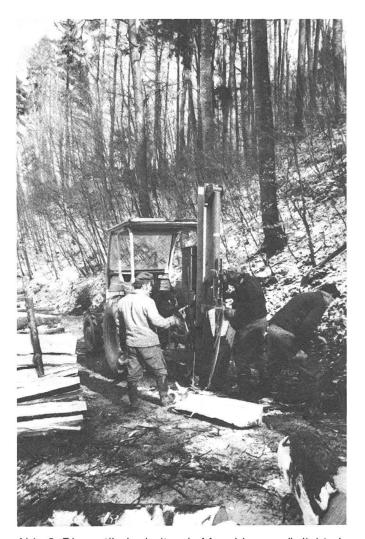
Abb. 6: Die vertikal arbeitende Maschine ermöglicht ein Arbeiten in aufrechter, gelöster Haltung. Die Anstrengungen beim Vorrücken der Rugel, Beschicken der Maschine, Spalten, Entnehmen und Einschichten der Spälten sind auf ein Minimum reduziert (Foto EAFV).
