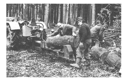
Abb. 8: Mit enormer Kraftanstrengung und ungünstigen Körperhaltungen wird diese horizontal arbeitende Spaltmaschine beschickt. Das Gewicht des Eichenrugels dürfte 100 kg betragen (Foto BAF, L. Rigling).
