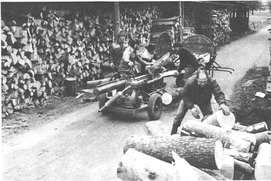
Abb. 5: Das Holz wurde in kranlanger Form an den revierzentralen Lager- und Verkaufsort gebracht und mit der Motorsäge in 1-m-Rugel eingeschnitten. Die Rugel werden zur Spaltmaschine gerollt. Die hydraulisch angetriebene Zuführgabel hebt die Lasten auf das Spaltaggregat. Die Spalten werden in Bündelkarren zum Lagerort geführt und dort aufgeschichtet (Foto BAF, L. Rigling).
