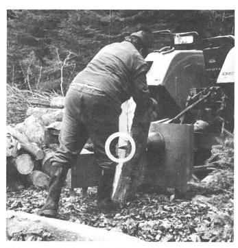
Abb. 4: Bei dieser Spaltmaschine mit konischer Schraube ist der Verdrehschutz für 1-m-Holz zweckmässig angebracht. Die im Vergleich zu Keil-Spaltmaschinen hohe Unfallgefahr durch unbeabsichtigtes Berühren der Schraube ist deutlich zu erkennen (Foto BAF, L. Rigling).
