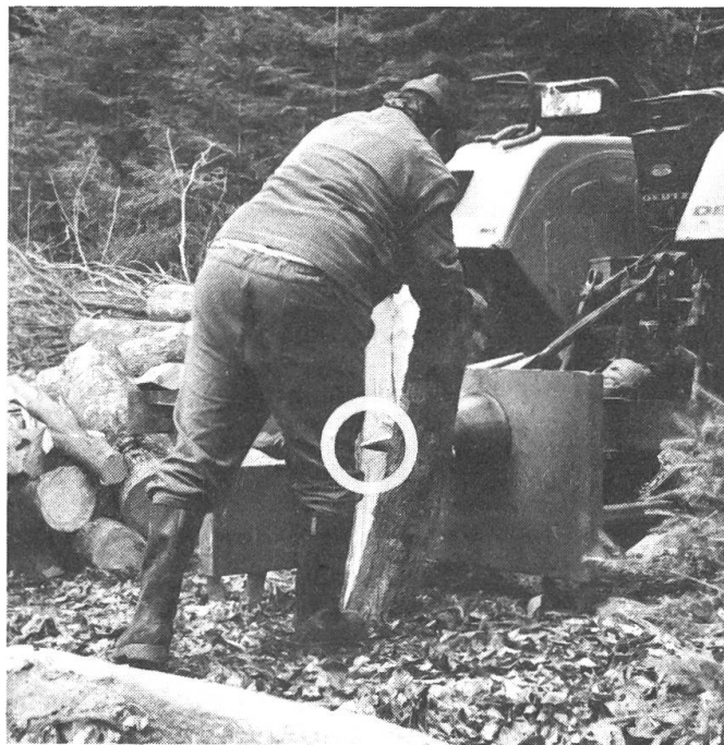
Abb. 4: Bei dieser Spaltmaschine mit konischer Schraube ist der Verdrehenschutz für 1-m-Holz zweckmässig angebracht. Die im Vergleich zu Keil-Spaltmaschinen hohe Unfallgefahr durch unbeabsichtigtes Berühren der Schraube ist deutlich zu erkennen (Foto BAF, L. Rigling).
