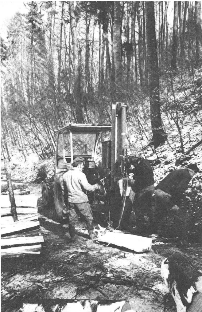
Abb. 6: Die vertikal arbeitende Maschine ermöglicht ein Arbeiten in aufrechter, gelöster Haltung. Die Anstrengungen beim Vorrücken der Rugel, Beschicken der Maschine, Spalten, Entnehmen und Einschichten der Spalten sind auf ein Minimum reduziert (Foto EAFV).
