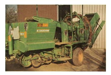
Abb. 1: Die Reinigung der Maschine ist noch bei möglichst warmem Wetter vorzunehmen, damit sie gut trocknet und Korrosionsschäden dadurch vermieden werden. Hochdruckreiniger und chemische Reinigungsmittel erleichtern diese Arbeit wesentlich. Der Einsatz solcher Hilfsmittel setzt aber Fachkenntnis voraus, sollen keine Schäden an Maschinen und Umwelt entstehen.
