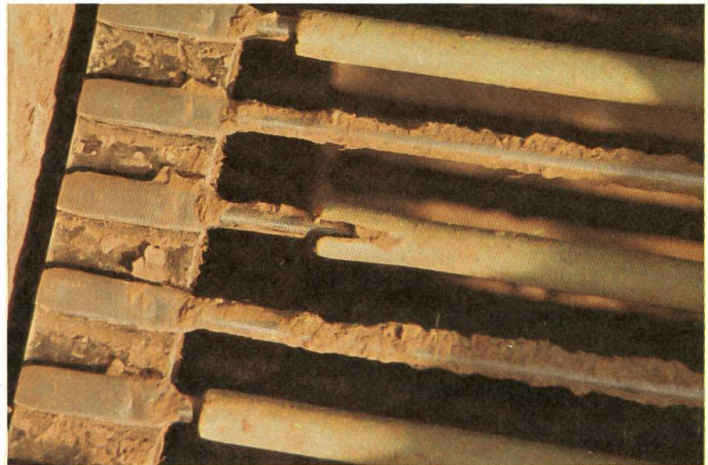
Abb. 7: Noppenbänder, Trennvorrichtungen und die Bespannung des Hubrades auf Beschädigungen und Abnutzung untersuchen und nötigenfalls ersetzen. Gummitteile mit speziellem Konservierungsmittel oder Glycerin einsprühen.
