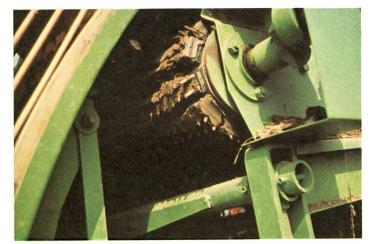
Abb. 7: Noppenbänder, Trennvorrichtungen und die Bespannung des Hubrades auf Beschädigungen und Abnützung untersuchen und nötigenfalls ersetzen. Gummiteile mit speziellem Konservierungsmittel oder Glyzerin einsprühen.
