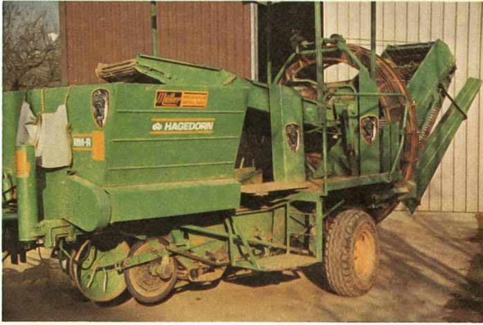
Abb. 2: Schutzvorrichtungen, der Sicherheit von Mensch und Maschine dienende Bauteile (Abdeckungen, Überlastkupplungen u.a.m.), sind auf ihre Funktion und die richtigen Einstellwerte zu prüfen.
