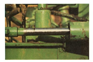
Abb. 5: Kolbenstangen nach Möglichkeit einfahren oder mit dauerhaftem Rostschutz behandeln.
