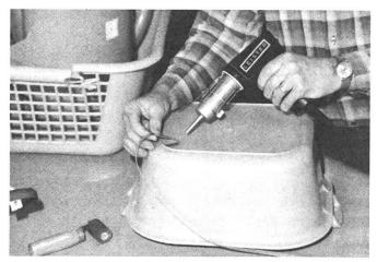
Abb. 2: Reparieren kleiner Defekte an Haushaltgeräten, welche meistens aus Polyäthylen hergestellt sind. Die zum Gerät gehörenden passenden Schweissdrähte in diversen Farben erlauben häufig eine zuverlässige Reparatur.
