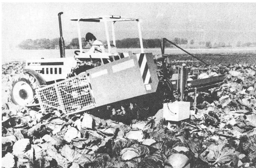
Bei diesem Kohl vollernter nehmen 2 gegenläufig rotierende Schnecken den Kohlkopf auf, übergeben diesen auf ansteigende Schnecken, die den Kohlkopf zum Schnitt mit der Kreissäge führen. Die abgeschnittenen Kohlköpfe können auf nebenherfahrende Wagen gefördert werden.
