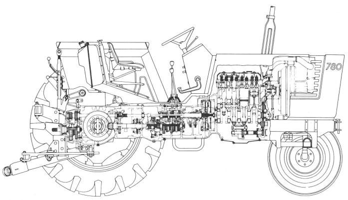
Abb. 2: Längsschnitt eines Traktors mit Hinterachsantrieb
