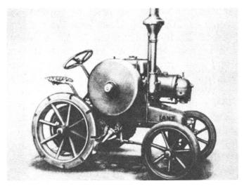
Abb. 1: 12-PS-Lanz-Bulldogg-Schlepper (1921) mit Einzylinder-Glühkopfmotor, ein Schrittmacher der bäuerlichen Motorisierung.
