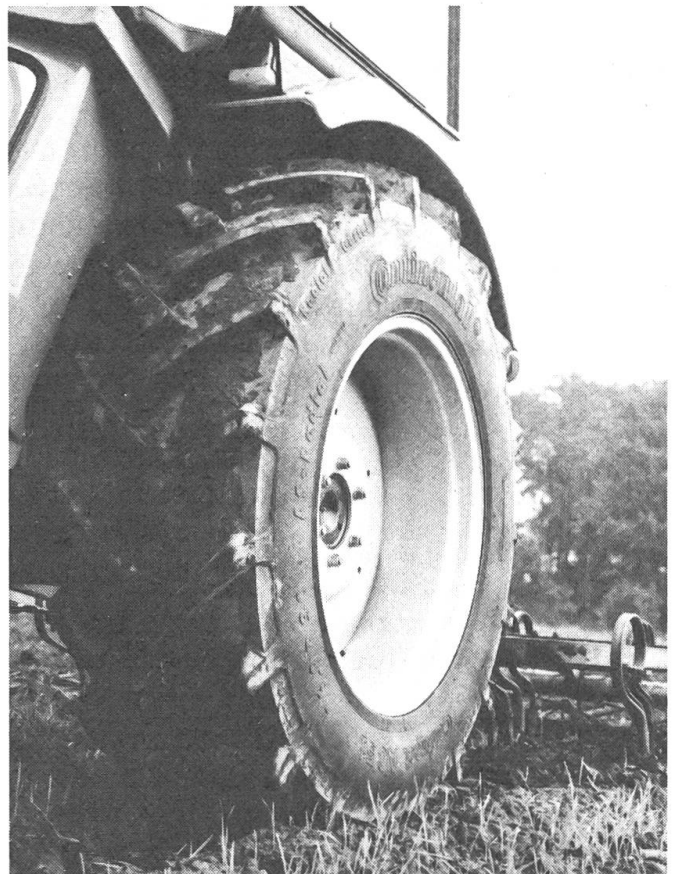
Abb. 2: Der Traktor-Gürtelreifen Conti-Contract AC 50 wurde zum AC 51 weiterentwickelt. Aber die Profilhöhe und Stollenform blieben unverändert, ebenso die glatten und grossen Flächen zwischen den Stollen, die für die Selbstreinigung auf schweren Böden unerlässlich sind. Dagegen wurde die Laufflächenschulter geändert. Eine umlaufende Profilkante sorgt für noch grössere Festigkeit und Widerstandsfähigkeit gegen Verletzungen. Eine Leiste über dem Felgenhorn verhindert das Eindringen von Erde und Fremdkörpern und schützt die Felgenkante.
