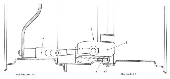
Punkt gegen den Anschlag gedrückt. Ein Aufspringen wird damit für alle Fälle verhindert. Ein weiteres wichtiges Sicherheitsmerkmal besteht darin, dass die Verschlüsse unabhängig voneinander spannen; fällt einer aus, so sind immer noch andere da, die das Doppelrad festhalten. Diese positiven Erfahrungen wurden auch mit dem bereits jahrelang bekannten Modell SO gemacht. Da die gesamte Länge des HD-
