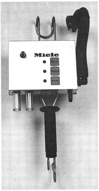
Spritzwasser geschützt – in dem stabilen rostfreien Metallgehäuse des Melkautomaten, einer handlichen, kompakten Einheit, untergebracht.
