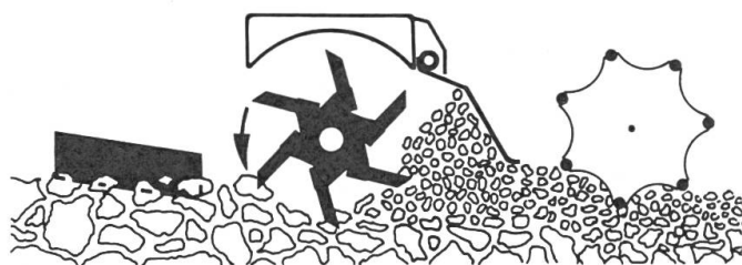
Abb. 2: Arbeitsweise des RAU-ROTOTILLERS. Planiereinheit Rotor Prallblech Tragwalze
