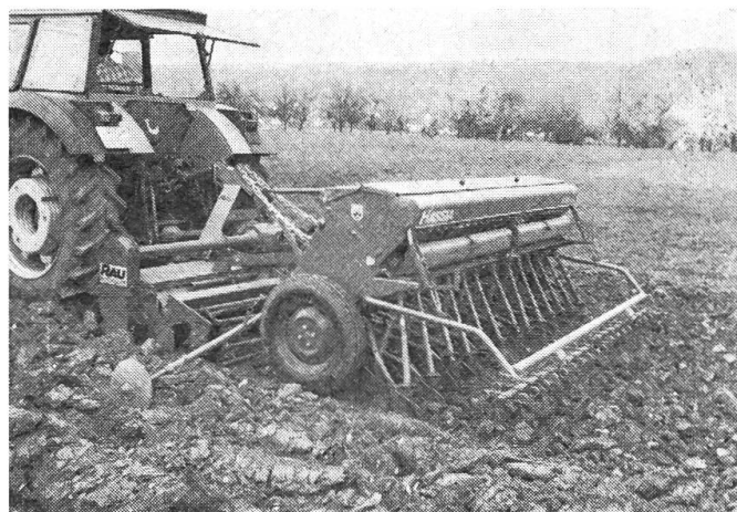
Abb. 3: RAU-ROTOTILLER mit 3-Punkt-Drillmaschine kombiniert. — Eine bodenschonende, energiesparende und schlagkräftige Methode ohne besonderes Risiko bei der Aussaat. Auf kurzen, gewichtsgünstigen Anbau der Drillmaschine über die Schnellkupplung «Tillerhitch» wurde besonders geachtet.
