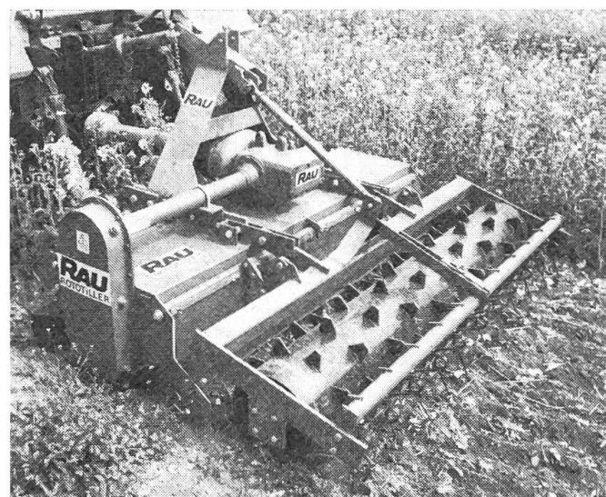
Abb. 4: RAU-ROTOTILLER. — 2 m breit, mit selbstreinigender Packerwalze ausgerüstet. Für das Einarbeiten von Gründung kann der Rototiller mit einem Fräsmesser -Rotor ausgerüstet werden. (RAU-Werkbilder)
