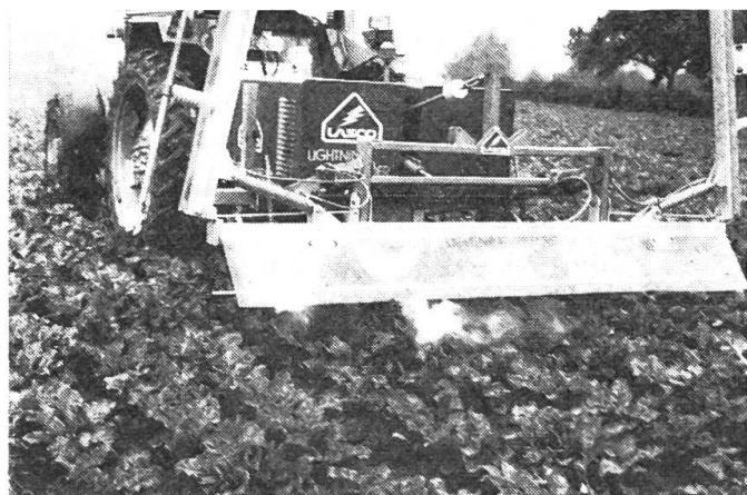
Abb. 2: Vom «Blitzschlag» getroffen: Ein 8000-Volt-Schlag zerstört die Zellen der Schosserrüben; noch bleibt abzuwarten, ob dieser amerikanische Prototyp serienreif werden wird.
