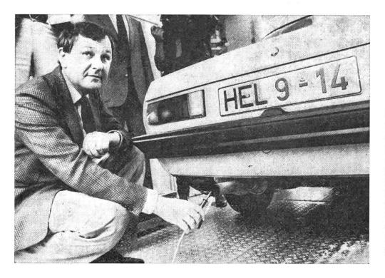
Der hessische Umweltminister prüft eigenhändig den Kohlenmonoxydgehalt im Abgas einer der mit einem Degussa-Abgaskatalysator ausgerüsteten neuen Dienstfahrzeuges. Ergebnis: Durch den Katalysator wurde der CO-Gehalt im Leerlauf von 4,5 auf 0,5%, im Teillastbereich von 1,6 auf 0,0% gesenkt.
