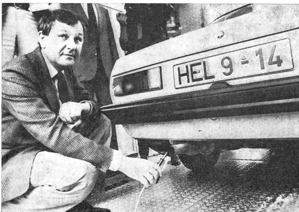
Der hessische Umweltminister prüft eigenhändig den Kohlenmonoxidgehalt im Abgas einer der mit einem Degussa-Abgas-Katalysator ausgerüsteten neuen Dienstfahrzeuge. Ergebnis: Durch den Katalysator wurde der CO-Gehalt im Leerlauf von 4,5 auf 0,5%, im Teillastbereich von 1,6 auf 0,0% gesenkt.
