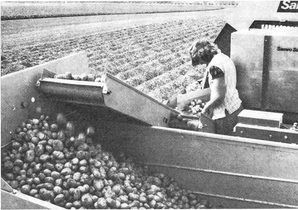
Arbeitsplatz der Kontrollperson. Die Bedienungsorgane befinden sich in Reichweite (hinter der Person).
