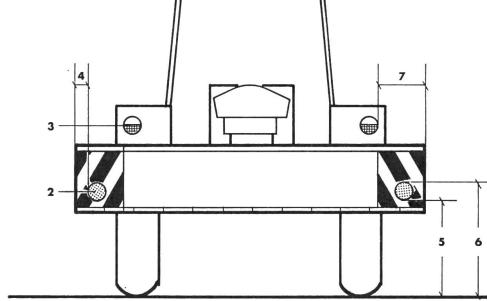
1 A: Die Lichter und Richtungsblinker des Motorfahrzeuges sind nicht verdeckt.
