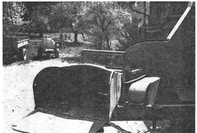
Abb. 4: Holzhacker müssen eine gut greifbare Vor- und Rückwärtsschaltung aufweisen.
