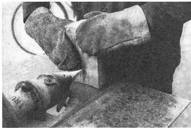
Abb. 6: Nie mit Handschuhen (auch nicht Fingerhandschuhen) an der Holzspaltmaschine arbeiten.
