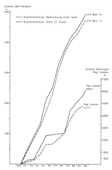
Abb 1: Vergleich der Betriebsstunden und bereinigte Reparaturkosten der beiden Stallmiststreuer
