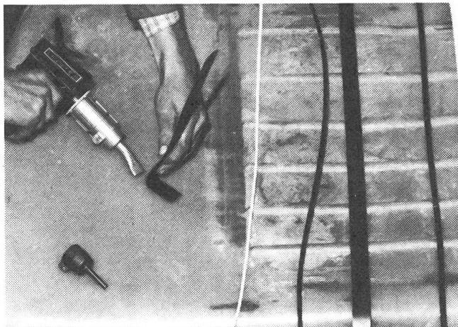
Reparaturschweissung an einem Polyäthylentank. Viele Tanks, Rohre, Körbe und Eimer bestehen aus dem gut schweisbaren Polyäthylen.
