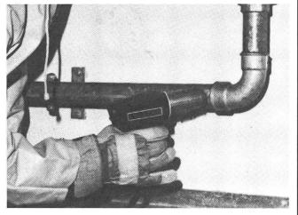
Auftauen von Wasser- und Diesel-Leitungen am Traktor im Winter mit dem kräftigen Heissluftstrahl des Leister-Ghibli. Warmluftzufuhr in den Ansaugkanal des Vergasers bedeutet Starthilfe.
