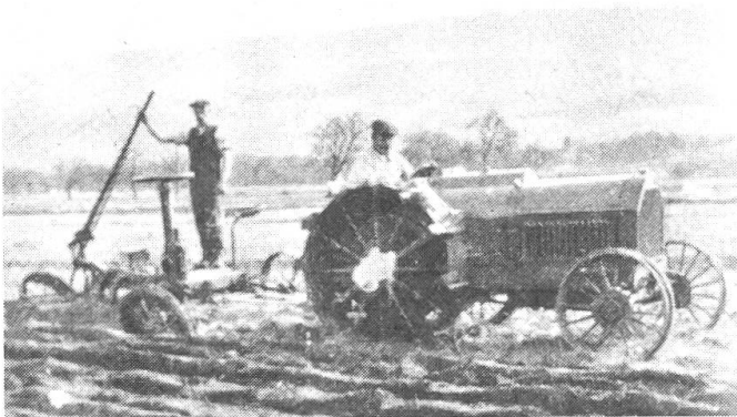
Schwedischer Avance-Motorflug, 1917 importiert durch Bucher-Manz, Niederweningen (Rohölmotor, 1 Zyl.)
