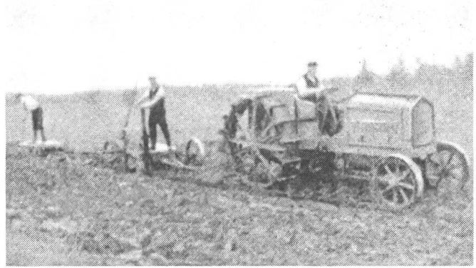
Berna-Traktor der Berna AG, Olten, 4-Zyl.-Benzinmotor (1918) – Ott 3-Schar-Pflug.
