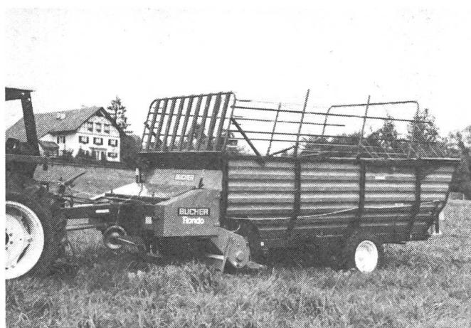
das entsprechende Messer hoch, was das automatische Abschalten des ganzen Förderorgans bewirkt. Ein eintretender Fremdkörper wird dadurch nicht (wie bei bisherigen Systemen) ins Futter gefördert, sondern vom Schneidwerk ausgeschieden und kann von außen vorne, ohne Entleerung des Wagens, entnommen werden. Anschliessend kann das Förderaggregat mit einem Hebel wieder eingeschaltet werden.
