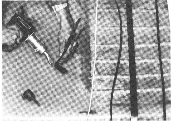
Reparaturschweissung an einem Polyäthylentank. Viele Tanks, Rohre, Körbe und Eimer bestehen aus dem gut schweisssbaren Polyäthylen.
