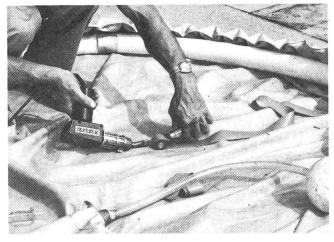
Reparaturschweissung an einer wassergefüllten Silopresse. Blachen und Traktorplanen bestehen meistens aus gut schweissbaren Polyätylen- oder PVC-Folien.
