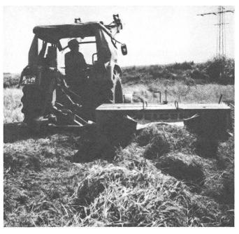
stoffhaltiges Futter einbringen – das ist mit dem neu entwickelten WELGER-Mähknickzetter möglich. Die Maschine hat einen guten Aufbereitungseffekt. Dank den verschiedenen Einstellmöglichkeiten, lassen sich unterschiedliche Futterarten optimal aufbereiten. Mit wenigen Handgriffen ist der Zinkenrotor ausgebaut, und das Mähwerk kann ohne Knicker eingesetzt werden. Lassen Sie sich am AGRAR-Stand über diese und viele weitere Neuerungen orientieren.
