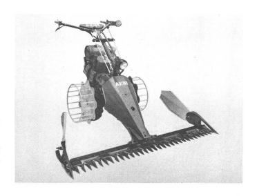
er aber auch ein vollwertiger Bergmäher und -heuer (Gitter- oder Doppelräder) mit tiefem Schwerpunkt und idealer Gangabstufung. Ausserdem besitzt der Einachser einen komfortablen, auf Gummielementen gelagerten und fürs Bodenfräsen seitlich schwenkbaren Lenker mit griffgerechten Bedienungselementen. Der neue AM 16 – eine Spezialmaschine für viele Arbeiten.
