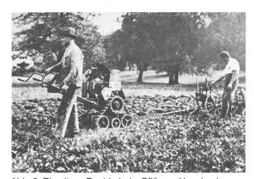
Abb. 2: Ein alter «Rapid» beim Pflügen. Um eine bessere Zugleistung zu erreichen, wurde er mit «Raupen» ausgerüstet.
