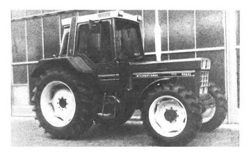
matischen Differentialsperre» ausgerüstet. Die IH-Synchrongetriebe mit 16 Vorwärtsund 8 Rückwärtsgängen haben eine Druckumlaufschmierung. Der Wirkungsgrad
