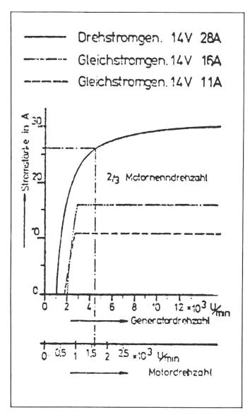
Abb. 2: Die Leistungskennlinie eines Drehstromgenerators 14 V 28 A im Vergleich zu einer Gleichstrommaschine 11 bzw. 18 A.
