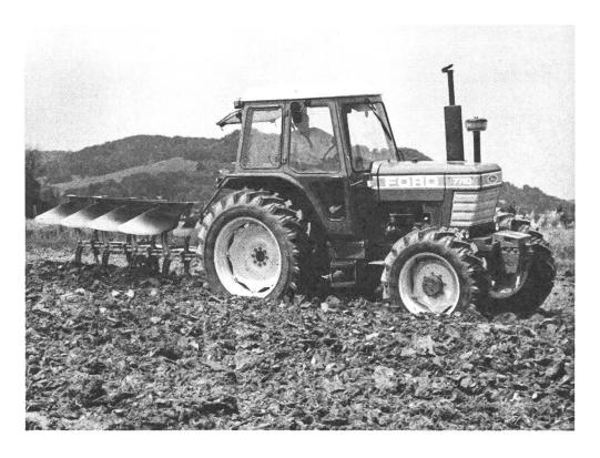
Abb. 3: Das Modell 7710 mit 4 Zylinder-Turbo-Dieselmotor, 4303 cm³, Lenktriebachse mit Differentialsperre, Zentralantrieb mit 52 Grad Einschlag. 16 Vorwärts- und 8 Rückwärtsgänge, Ford-Kabine (82 dBA).
