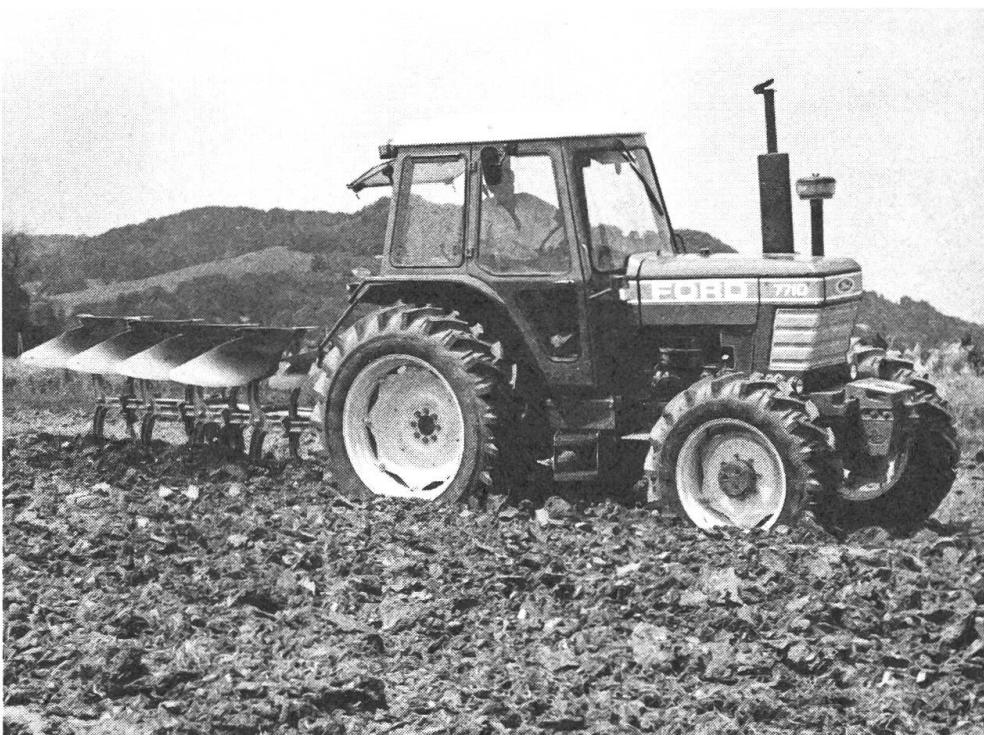
Abb. 3: Das Modell 7710 mit 4 Zylinder-Turbo-Dieselmotor, 4303 cm 3 , Lenktriebachse mit Differentialsperre, Zentralantrieb mit 52 Grad Einschlag. 16 Vorwärts- und 8 Rückwärtsgänge, Ford-Kabine (82 dBA).
