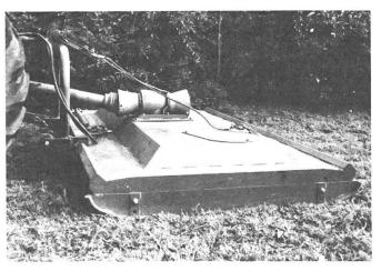
wird mit Kufen, Schwenkräder, Tellern (nur Bingo 3) oder Laufwalze ausgerüstet. Der Votex Bingo wird für Seitenausladung serienmässig mit verstellbarem 3-Punkt-Bock ausgerüstet. Für grosse Seitenausladung kann ein leicht verstellbarer 3-Punkt-Bock geliefert werden, der auch hydraulisch verstellt werden kann. Der Sichelmäher hat ein stabiles, glattes und robustes, aus wenigen Teilen gefertigtes Gehäuse und unverwüstliche, nachstellbare Kegelrollenlager in der Messerlagerung.
