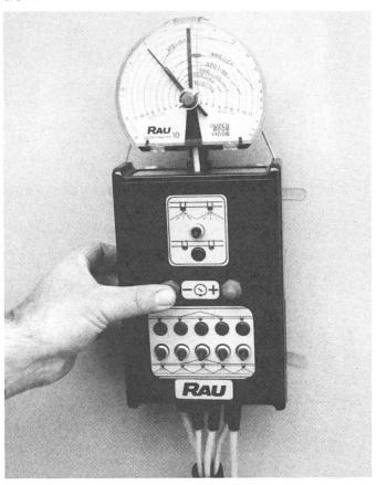
Neues Rau-Quanto-Quick-Schaltpult für halbautomatische wegabhängige Dosierung (Werkfoto Rau)
