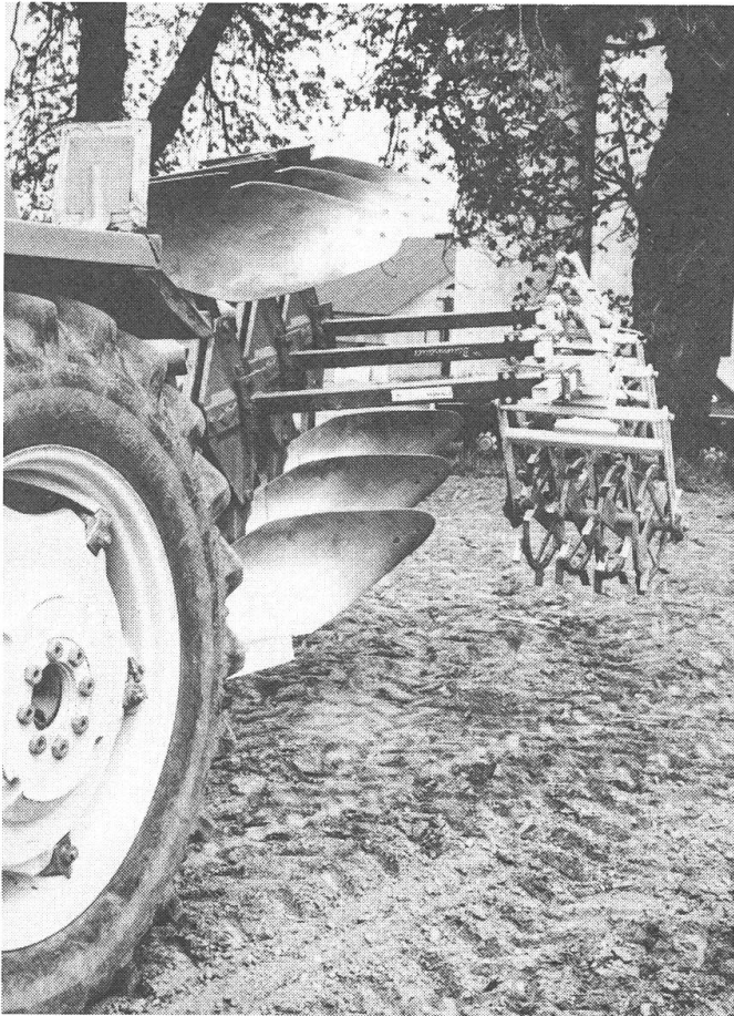
Abb. 2: Der «Graper» schwenkt beim Wenden des Pfluges mit. Dadurch ist für beide Seiten nur eine Einheit pro Pflugkörper notwendig.
