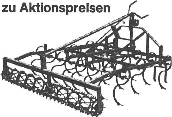
für 3-Punkt-Anbau, mit 4 Zinkenreihen und über Spindeln höhenverstellbarem Spitzzahn-Ein- oder -Zweiwalzenkrümler.
