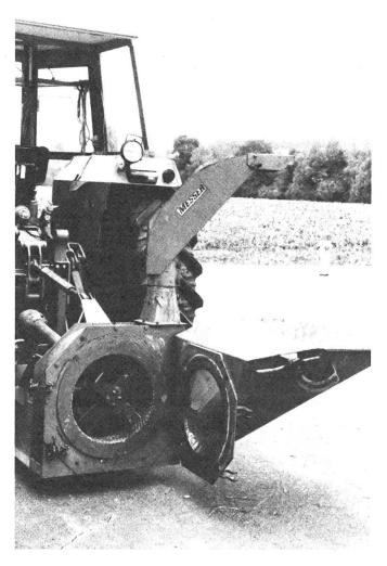
Abb. 10: Feuchgetreidemühle. Das Rundsieb kann je nach Feuchtigkeitsgehalt und gewünschter Mahlfeinheit schnell und einfach gewechselt werden. Für CCM in der Regel 18 mm Lochdurchmesser. Antrieb mindestens 80 kW bei 12 t Durchsatz pro h oder 50 kW bei 9 t/h.
