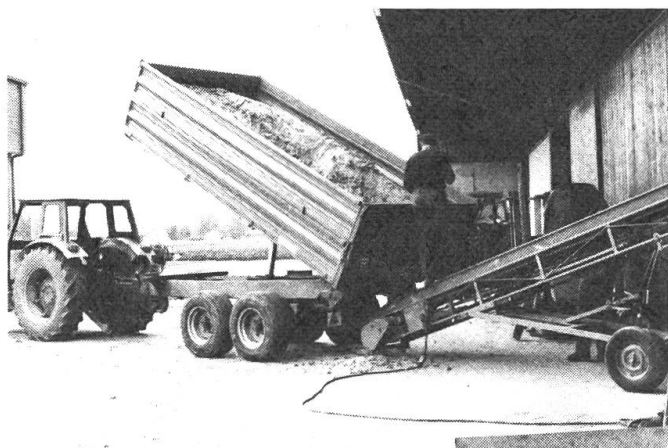
Abb. 9: Der Durchsatz bei den Feuchtgetreidemöhlen wird von der Dosierung stark beeinflusst. Dosierung ab Transportwagen genügt in der Regel nicht. Eine regelmässige Beschickung wird mit Förderband oder durch Transportschnecken mit mindestens 15 cm Durchmesser erreicht.
