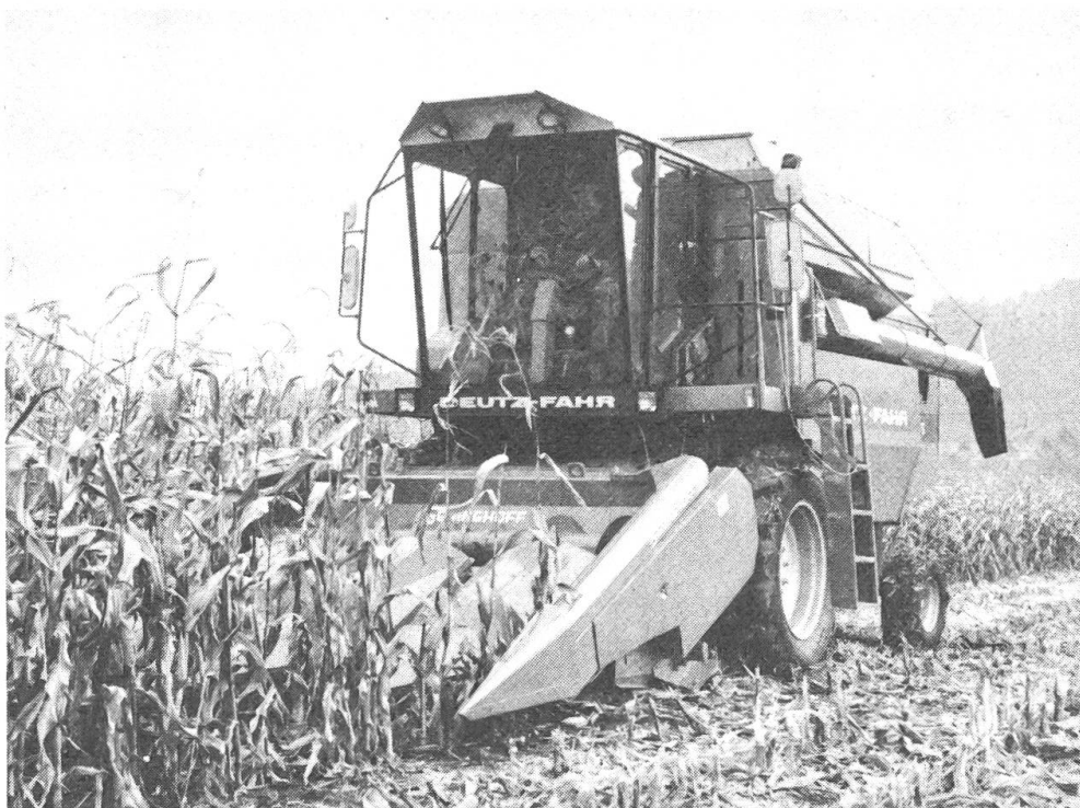
Abb. 3: In die Vergleichsversuche miteinbezogen wurde auch ein Mähdrescher herkömmlicher Bauart aus einer neuen Typenreihe (FAHR M 2780 H). Die Einzelaggregate solcher Neuentwicklungen sind von Grund auf auch für die CCM-Ernte abgestimmt.
