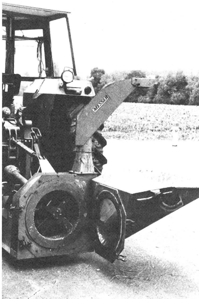
Abb. 10: Feuchtgetreidemühle. Das Rundsieb kann je nach Feuchtigkeitsgehalt und gewünschter Mahlfeinheit schnell und einfach gewechselt werden. Für CCM in der Regel 18 mm Lochdurchmesser. Antrieb mindestens 80 kW bei 12 t Durchsatz pro h oder 50 kW bei 9 t/h.
