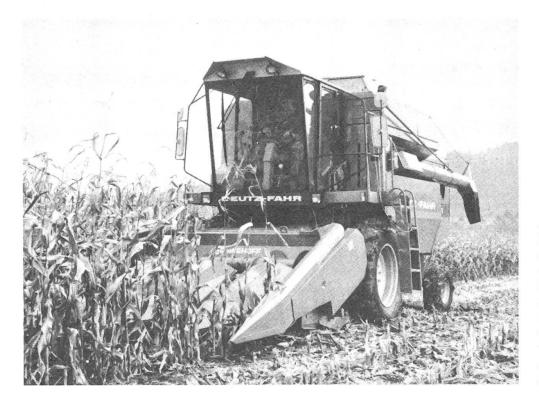
Abb. 3: In die Vergleichsversuche miteinbezogen wurde auch ein Mähdrescher herkömmlicher Bauart aus einer neuen Typenreihe (FAHR M 2780 H). Die Einzelaggregate solcher Neuentwicklungen sind von Grund auf auch für die CCM-Ernte abgestimmt.
