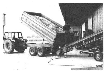
Abb. 9: Der Durchsatz bei den Feuchtgetreidemühlen wird von der Dosierung stark beeinflusst. Dosierung ab Transportwagen genügt in der Regel nicht. Eine regelmässige Beschickung wird mit Förderband oder durch Transportschnecken mit mindestens 15 cm Durchmesser erreicht.
