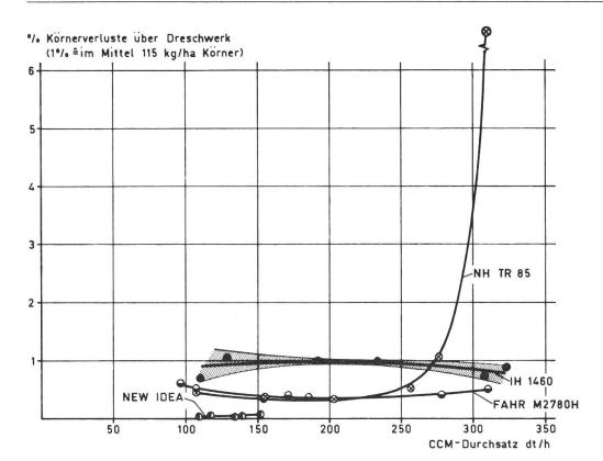
Abb. 6: Körnerverluste der Dreschwerke in Abhängigkeit vom CCM-Durchsatz.
