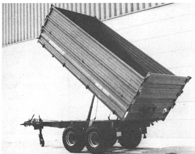
Einachs-Dreiseitenkipper MEDK 6500 TA mit Brückengrösse 4500 x 2100 mm. (Mengele-Werkfoto)
