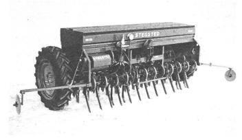
Stegsteds neue Ammoniakkombidrillmaschine wurde im Jahre 1981 in Dänemark ausprobiert. Der Mehrertrag der Sommergerste betrug, verglichen mit dem traditionellen Zuführen von Ammoniak 100-210 kg/ha. Da das Säen und die Zufuhr von Stickstoff im gleichen Arbeitsgang geschehen spart man auch noch Treibstoff und Zeit.
