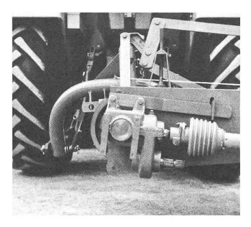
Für die Futterernte-Saison 1982 liefert BU-CHER-GUYER für die FAHR-Kreiselmäher mit Conditioner KM 22 CR und KM 24 CR als Wunschausrüstung ein Getriebe mit Anschlüssen für zwei verschiedene Rotordrehzahlen: 730 min[1 (Standardausrüstung) und 550 min[1 (zusätzlich).
