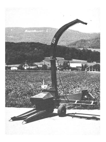
der Häckselqualität weitere, wesentliche Vorteile: Durch den exakten Kurzschnitt von 4,5 mm werden sämtliche Körner aufgeschlagen, was letzlich der Silagequalität zugute kommt.
