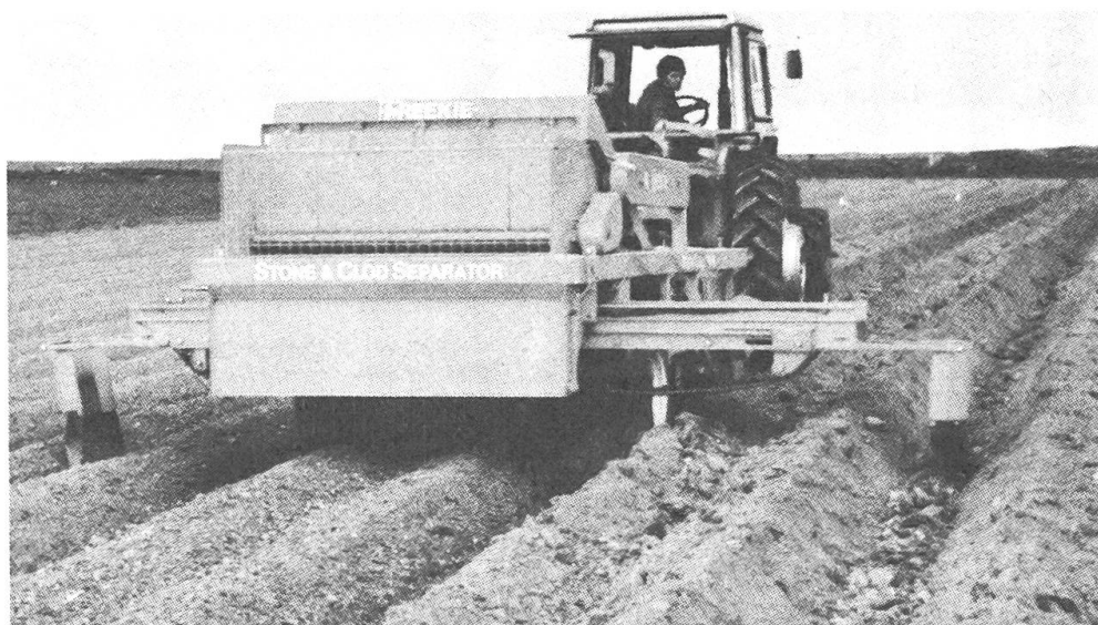
Abb. 6a und b: Spezialmaschine zum Entsteinen der vorgeformten Dämme (Reekie, GB). Die Ablage der ausgesiebten Steine und Schollen erfolgt zwischen die Reihen. Grössere Steine können gebunkert und am Feldrand deponiert werden. Diese Maschine kann auch mit einem Kartoffellegeautomaten ausgerüstet werden.
