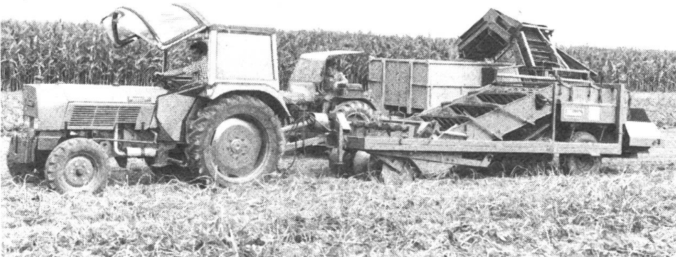
Abb. 8: Rodelader mit drei Siebbändern, drei Krautpupfwalzen und Überladeband (Hassia) beim Steinsammeln (oben) und Kartoffelroden (unten).
