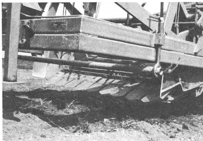
Abb. 9: Für den Einsatz als Steinsammler werden die Dammrollen des Rodeladers abgebaut und symmetrische Blattschare über die ganze Siebkanalbreite montiert.
