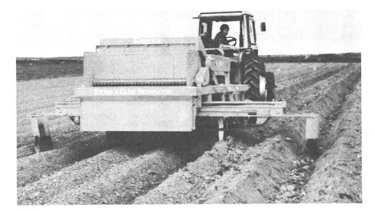
Abb. 6a und b: Spezialmaschine zum Entsteinen der vorgeformten Dämme (Reekie, GB). Die Ablage der ausgesiebten Steine und Schollen erfolgt zwischen die Reihen. Grössere Steine können gebunkert und am Feldrand deponiert werden. Diese Maschine kann auch mit einem Kartoffellegeautomaten ausgerüstet werden.
