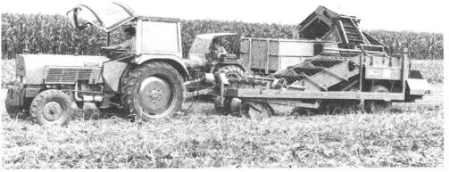
Abb. 8: Rodelader mit drei Siebbändern, drei Krautzupfwalzen und Überladeband (Hassia) beim Steinsammeln (oben) und Kartoffelroden (unten).
