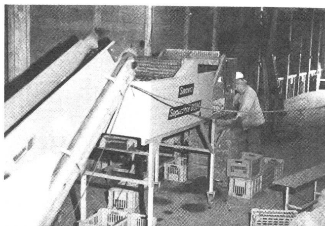
Abb. 5: Elektronische Trennmaschine für den stationären Einsatz (Samro). Die Beimengungen im Rodegut (Steine und Schollen) lassen sich mit hoher Genauigkeit ausscheiden. Eine Ausnahme bilden Steine über zirka 800 g Stückgewicht sowie Schollen von ausgesprochenen Moorböden.
