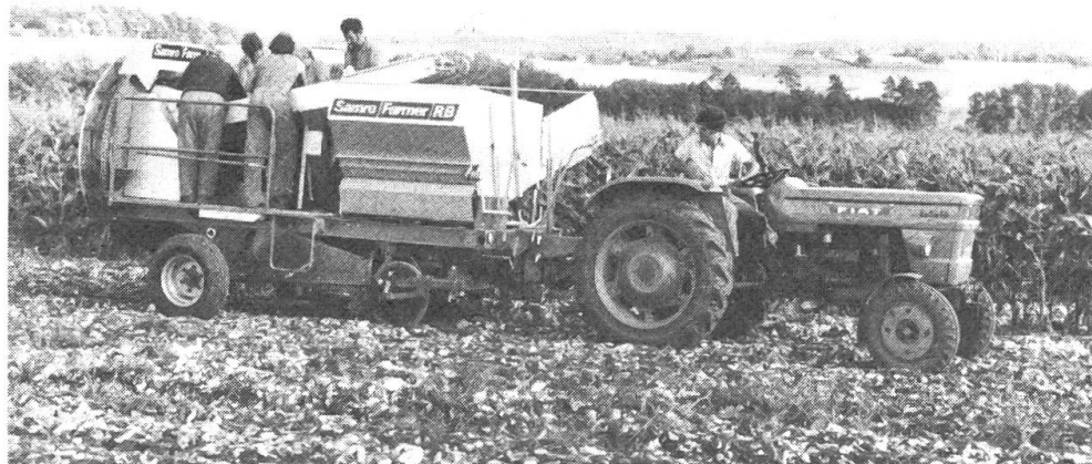
Abb. 1: Beim Vollernteverfahren werden alle Beimengungen auf der Erntemaschine ausgeschieden. Die Verlesearbeit wird in den meisten Fällen zum leistungsbegrenzenden Faktor.
