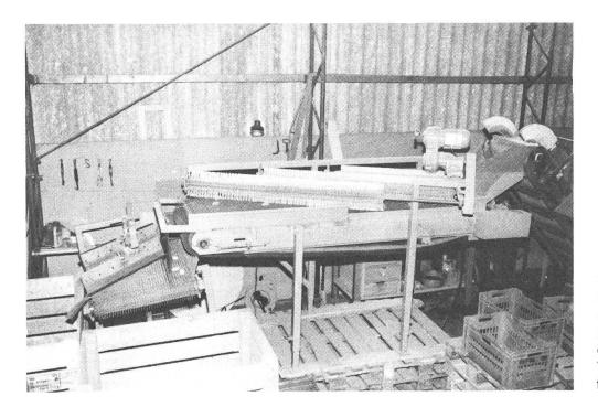
Abb. 10: Stationäre Trennanlage mit einem Bürstenwalzen-Igelband für die Stein-und einem Abstreiferband für die Erdausscheidung (Blaser). Gute Trennergebnisse sind möglich bei eher rundlichen Hartsteinen und weichen Schollen. Steine mit über 70 bis 80 mm Grösse und grosse harte Schollen lassen sich damit jedoch nur schlecht von den Kartoffeln trennen. In Verbindung mit dem Steinsammel-Rodeladeverfahren kann eine solche einfache Vorrichtung aber gut befriedigen.
