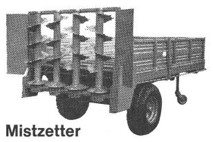
von 2 t bis 6 t, mit 4 stehenden Streuwalzen, Gelenkwelle, Beleuchtungsanlage, Bremsachsen, Bereifung 10 x 15, 11,50–15, 130/65–18. Metallaufbau, robuste Konstruktion, Dosierung von Sitz aus möglich.
