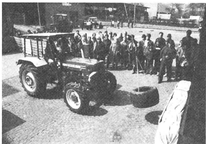
Abb. 4: Durch Anstossen mit der Traktorfront war ein aufgehängter Pneu so stark in Schwingung zu bringen, dass er wohl die Wand berührte, nicht aber beim Zurückschwingen den rückwärtsfahrenden Traktor «erwischte».
