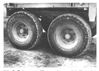
Abb. 5: Bei grossen Wagen oder wo viel siliert wird, kommt man um Tandem- oder Doppelachsen nicht herum.
