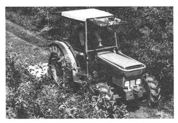
Abb. 6: Die grosszügig verglaste Sicherheitskabine auf diesem Spezialtraktor ist über Schnellverschlüsse abnehmbar. Ein Schadstoff-Filter schützt den Fahrer zuverlässig vor Spritz- und Sprühnebel.
