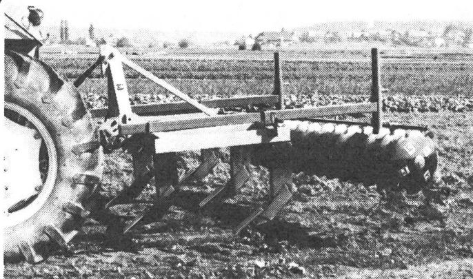
grubber mit Schnellkupplung mit Doppelspiralfederzinken. Ideal in Kombination mit
