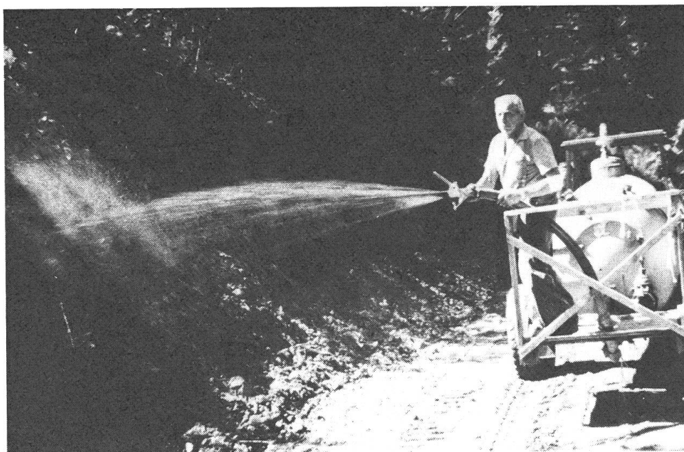
Abb. 2: Ein einfacher Holzanbau auf der Rückseite des Güllendruckfasses genügt, und schon kann die Bedienungsperson – gefahrlos stehend – das Mischgut verspritzen.
